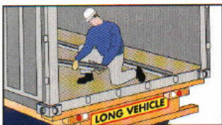
Die transportablen Kompaktschienen werden parallel auf dem Boden gelegt
